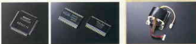
● 最新ATRAC10用ICチップ ● パルス生成器(先)、カレントパルスD/Aコンバーター用ICチップ(右) ● Rコアトランス
